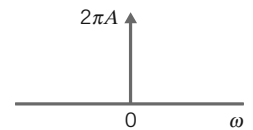
FIGURA 15.11-2 Espectro de señal de cd constante de magnitud A . El símbolo para un impulso es una línea vertical con una punta de flecha.
