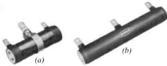
FIGURA 2.4-5 (a) Resistor embobinado con una tapa al centro ajustable. (b) Resistor embobinado con tapa fija. Cortesía de Dale Electronics.
